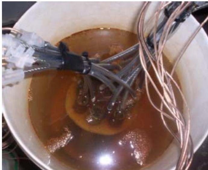
Wenn Sie die Rohre anfassen müssen um z.B. die Rohrenden zu reinigen, benutzen Sie einen Pinsel, aber fassen Sie die Rohre nicht an. Ravi's Erfahrung zeigt, das das entfernen des brauen Drecks nötig ist um so das erhitzen des Wassers zu verhindern. Genau darauf muß geachtet werden. Nach einiger Zeit wird die Menge an braunen Dreck weniger werden. Wenn dies der Fall ist, können Sie auch mit weniger Ampere die gleiche Schichtdicke erzeugen.
